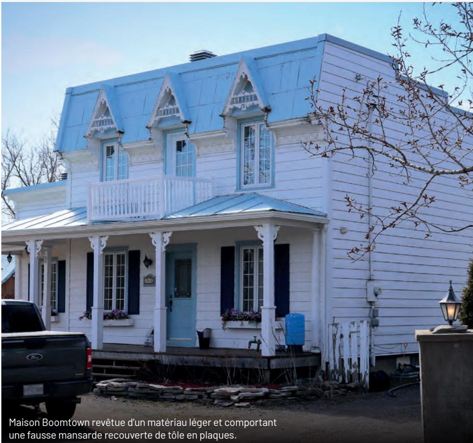
Maison Boomtown revêtue d'un matériau léger et comportant une fausse mansarde recouverte de tôle en plaques.
