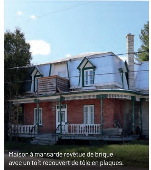
Maison à mansarde revêtue de brique avec un toit recouvert de tôle en plaques.
